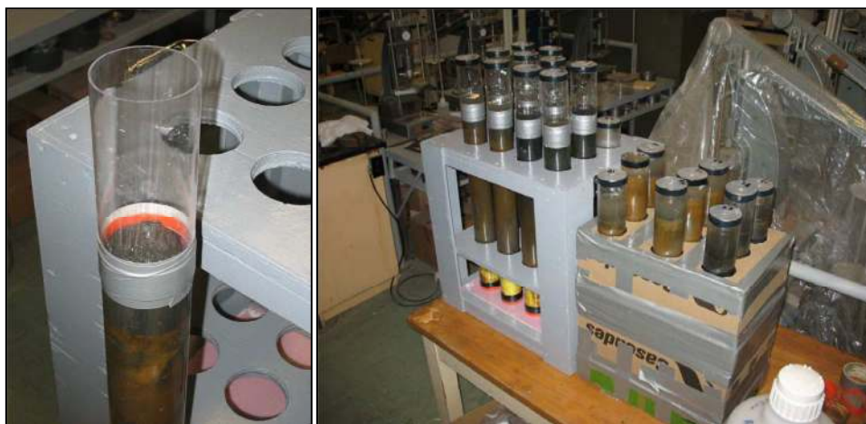
Figure III-8 Montage de l'essai de diffusion du phosphore
