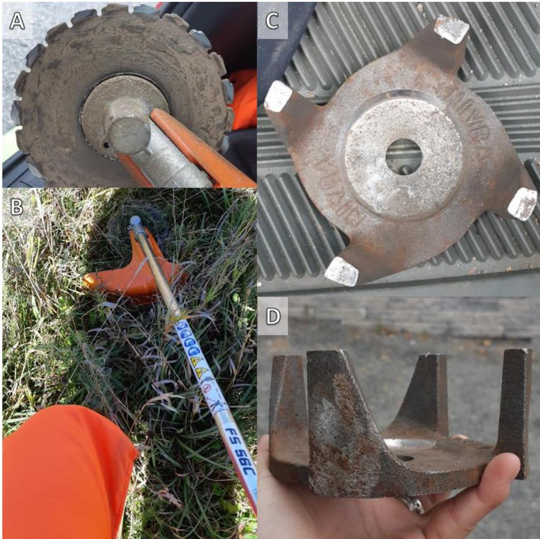
**Fig. 6:** Embout de la débroussailleuse vu du dessus (A), débroussailleuse au travail (B), embout de taupage vu du dessus (C), embout de taupage vu de côté (D).
