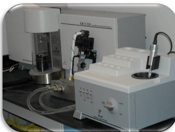
Photo 5.9 Appareil de mesure au laser pour déterminer la granulométrie des particules fines
