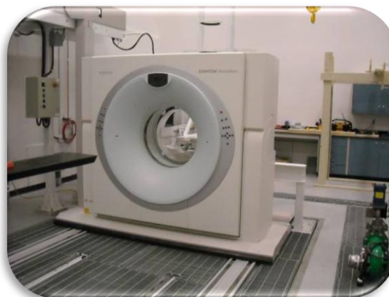
Photo 6.5 Appareil d'imagerie médicale utilisé pour reconstituer la stratigraphie des carottes de sédiments (INRS-ETE)
