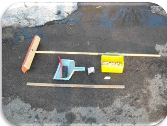
Photo 2.4 Équipement utilisé pour récolter les échantillons.
