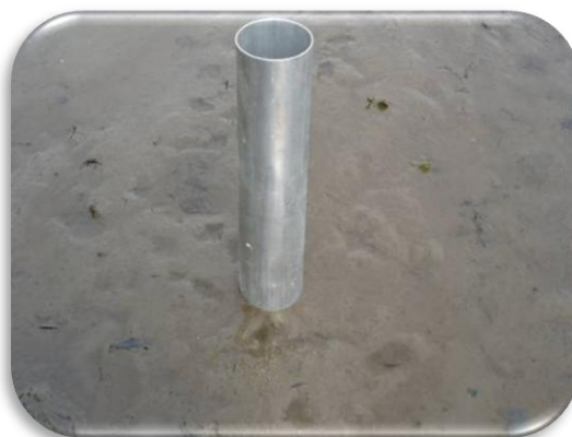
Photo 6.1 Tube utilisé pour prélever les carottes de sédiments
