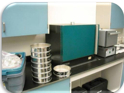
Photo 5.7 Tamis et dessicateur utilisés pour trier et sécher les sédiments
