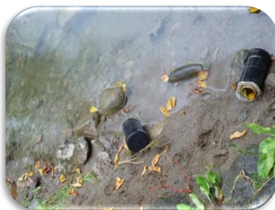
Photo 5.3 Trappes à sédiments arrachées au site T-2 le 27 septembre 2009
