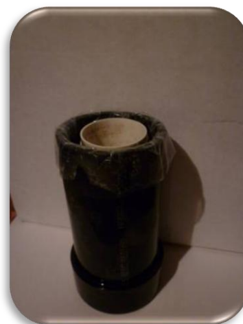
Photo 5.1 Concept retenu pour les trappes à sédiments développées par Roche
