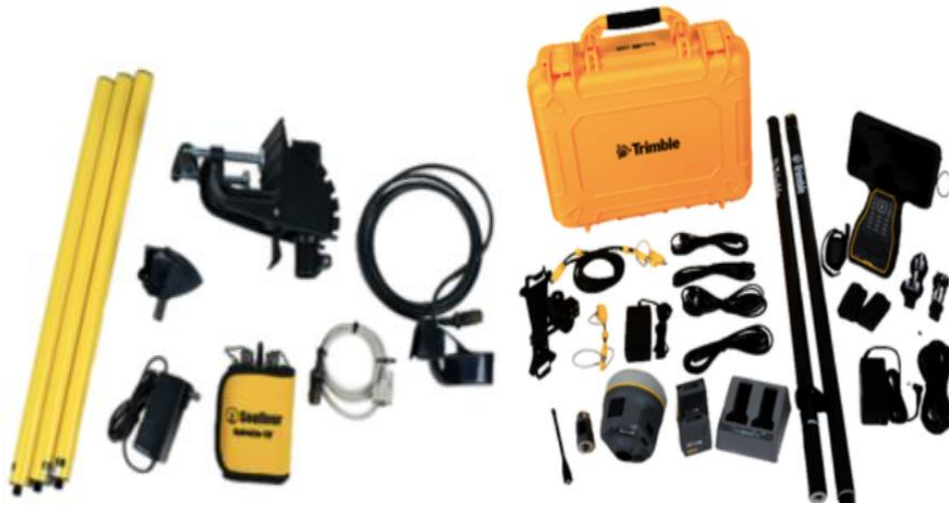
Figure 7: Échosondeur Seafloor hydrolite et GPS Trimble (Source Cansel, 2019).
