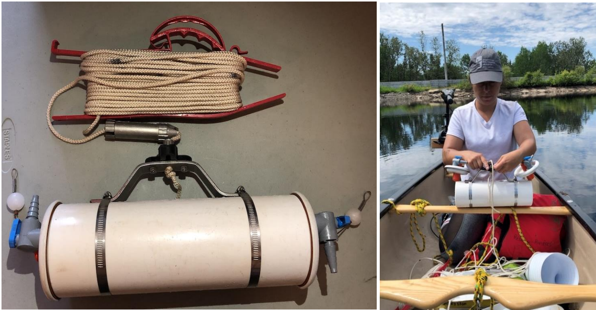
Figure 14 : Bouteille de type Van Dorn et échantillonnage à l'aide de celle-ci. (Source : Naömie Therrien-Janvier pour l'OBV de la Capitale, 2019)
