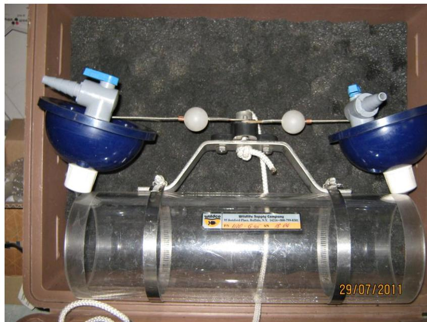
**Figure 3 : Bouteille d'échantillonnage d'eau horizontale modèle Alpha**
