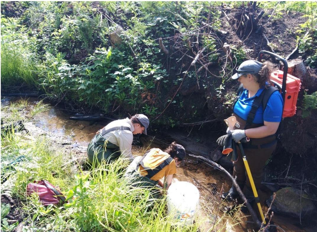
Figure 7. Identification de la communauté de poissons par la pêche électrique
