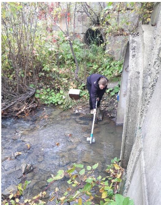
Figure 2. Échantillonnage à la perche au ruisseau Rouge
