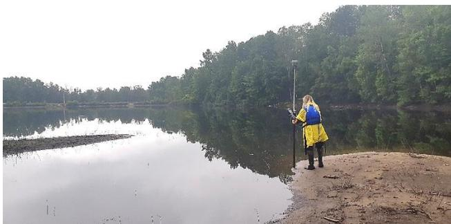
Figure 3. Prise de mesures bathymétriques.
