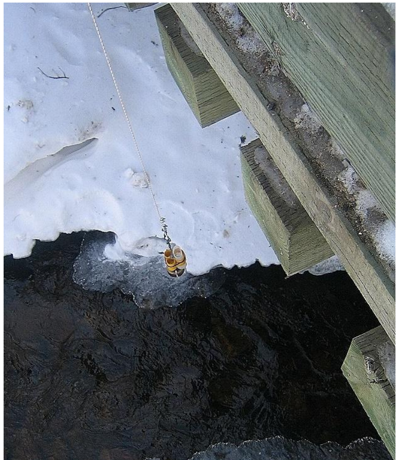
Photo 2: Prélèvement d'eau au point Hu2 - descente du porte-bouteille -
