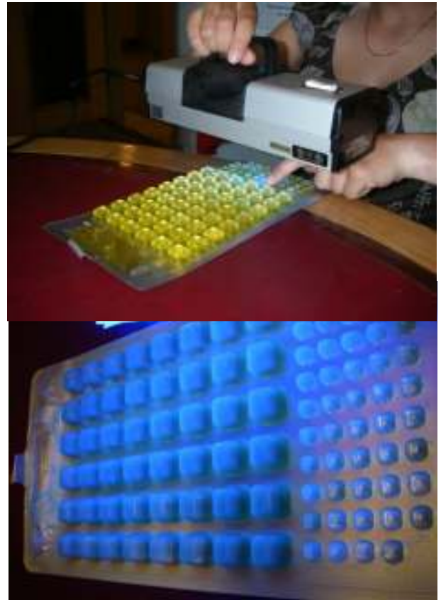
Photo 3 : Le dénombrement des puits indiquant une présence d'E. coli
