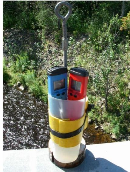
Photo 2: Mesure de la conductivité, du pH et des températures associées
