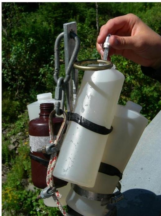
Photo 3: Deuxième prélèvement d'eau – prise de la température dans la bouteille *RNF*
