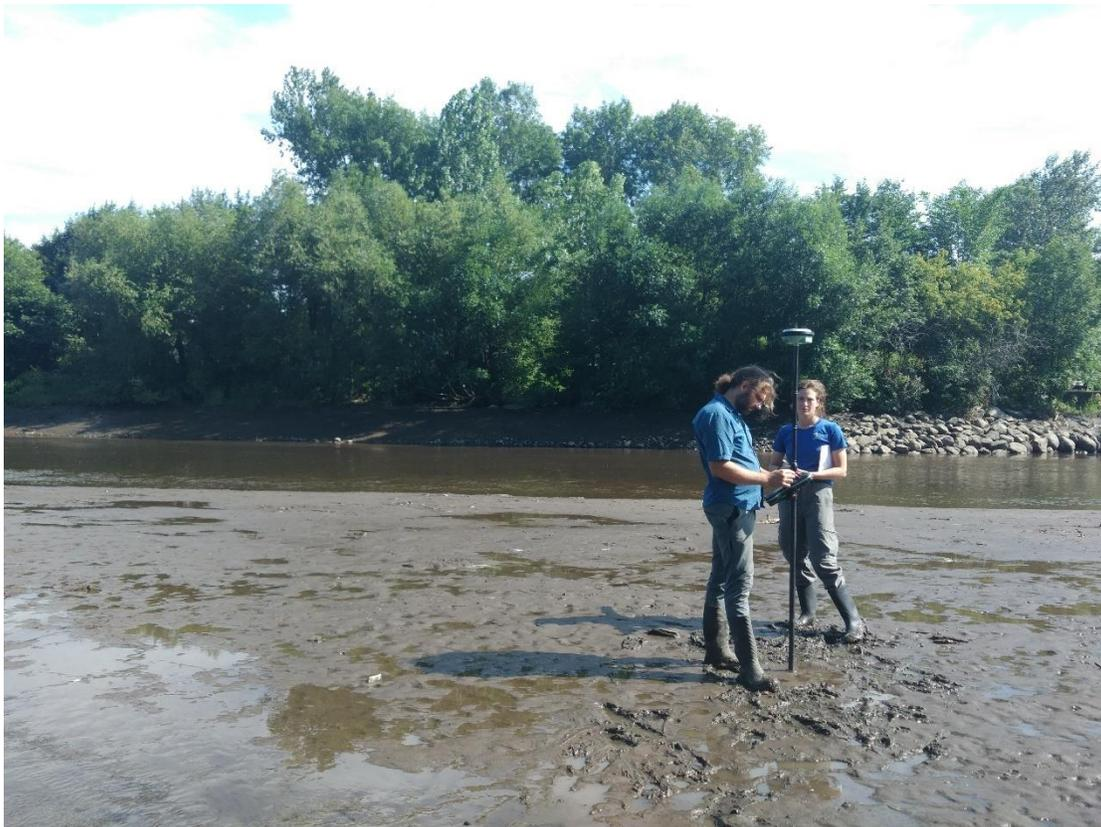
Figure 9 : Étape de marquage avec un GPS haute précision des zones sur l'îlot sableux.
