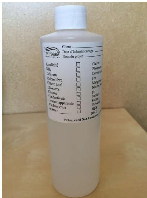
Photo 2 : Bouteille du laboratoire pour l'analyse des ions chlorure
