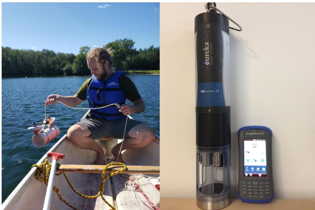
Figure 5 : Instruments d'échantillonnage et de prises de mesure de l'eau (à gauche : échantillonnage de l'eau à avec la bouteille Van Dorn; à droite : sonde multiparamètres)
