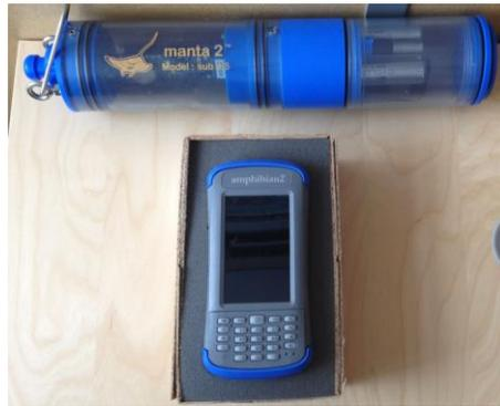
Figure 4.2 : Sonde Manta2 et le périphérique Amphibian2.
