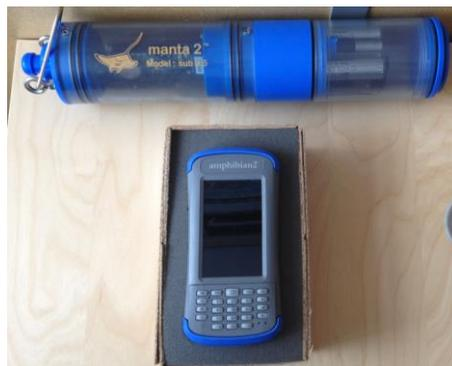
Figure 3.3 : Sonde *Manta2* et le périphérique *Amphibian2*.
