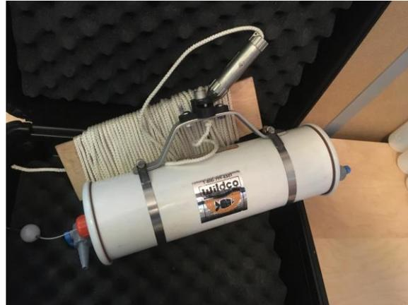
Figure 3.4 : Bouteille d'échantillonnage de type Van Dorn.
