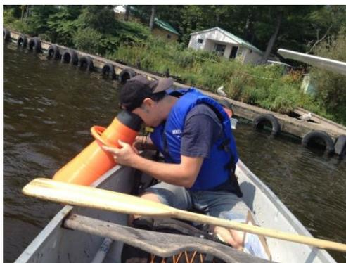
Figure 4-2: Utilisation de l'aquascope
