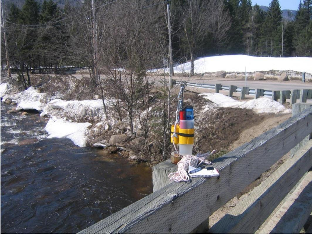
Photo 9-1 : Mesure de la conductivité et du pH à l'aide du porte-bouteille
