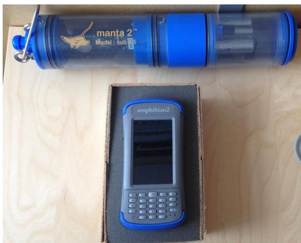
Figure 3-3. Sonde *Manta 2* et le périphérique *Amphibian 2*, utilisés pour mesurer les paramètres physicochimiques et biologiques de la qualité de l'eau du lac Saint-Augustin
